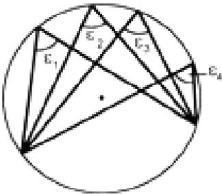
Alle **Peripheriewinkel** über gleichem Bogen sind gleich gross.
