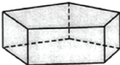
Ein Körper heisst gerades Prisma, wenn der Mantel ausschliesslich aus Rechtecken besteht.
